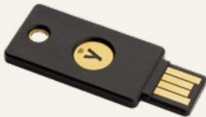
Une clé de sécurité est un dispositif portable que vous pouvez connecter à vos appareils via USB, Bluetooth ou NFC. Elle sert de méthode d'authentification pour EU Login.
